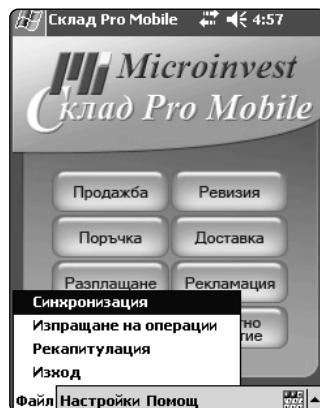
**Синхронизация** - стартира двупосочен обмен на информация между устройството и компютъра.
